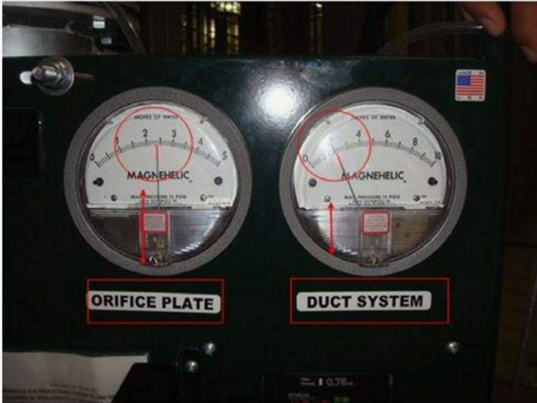
Magnehelic para el plato de orificio y para el interior del sistema de ductos
